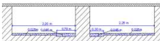
Gambar 2. a. : Potongan melintang aliran sungai pada Bangunan Terjunan
