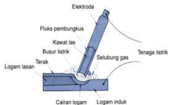
Gambar 1 Las busur dengan elektroda terbungkus (Harsono Wirjosumarto, 2000).
