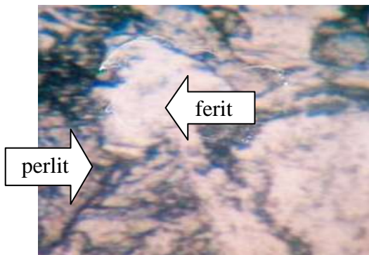
Gambar 10. Struktur mikro daerah HAZ
