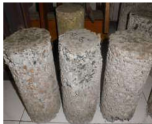
Gambar 8. Kerusakan beton dengan split Clereng faktor air semen 0.4
