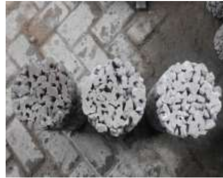
Gambar 4. Sisi bawah silinder beton dengan agregat split Clereng
