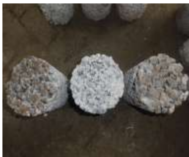
Gambar 3. Sisi bawah silinder beton dengan agregat split Merapi
