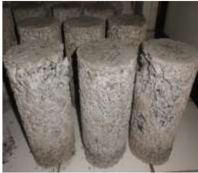
Gambar 9. Kerusakan beton dengan split Clereng faktor air semen 0.5
