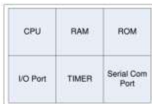
Gambar 1. Isi Chip Mikrokontroler
