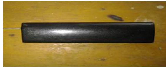
Gambar 4. Model airfoil dengan vortex generator
